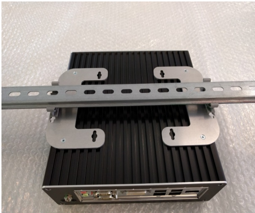
Fig. 2: Montage auf Hutschiene (Beispiel)
