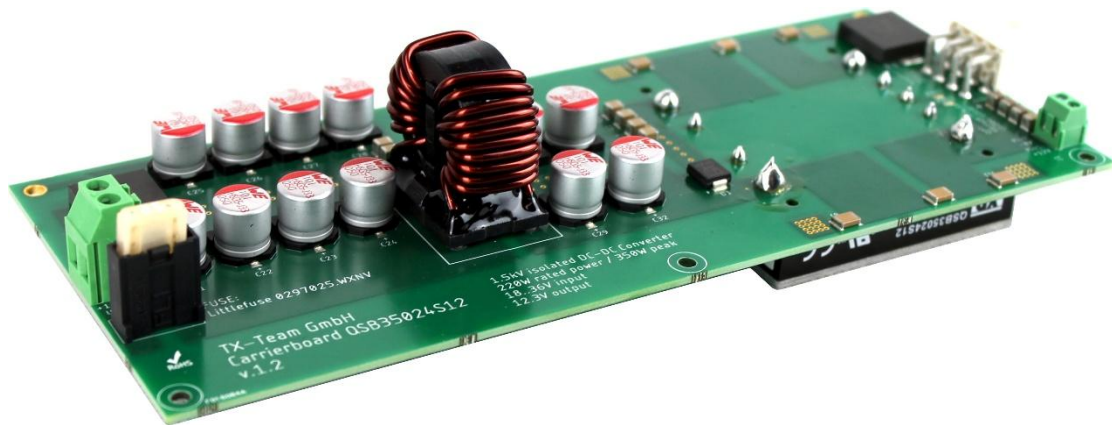
Abb. 2: Beispiel für ein internes DC-DC-Wandlermodul mit Weitbereichseingang
