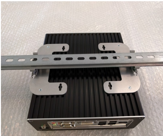
Fig. 2: Montage auf Hutschiene (Beispiel)
